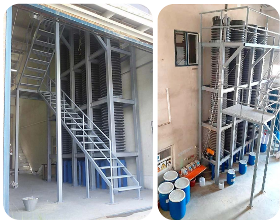
شکل ۱۱- ستون‌های شش متری آزمایش‌های پایلوت لیچینگ سونگون
